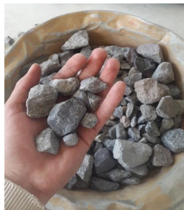
Observación de las caras fracturadas Clasificación de caras fracturadas
