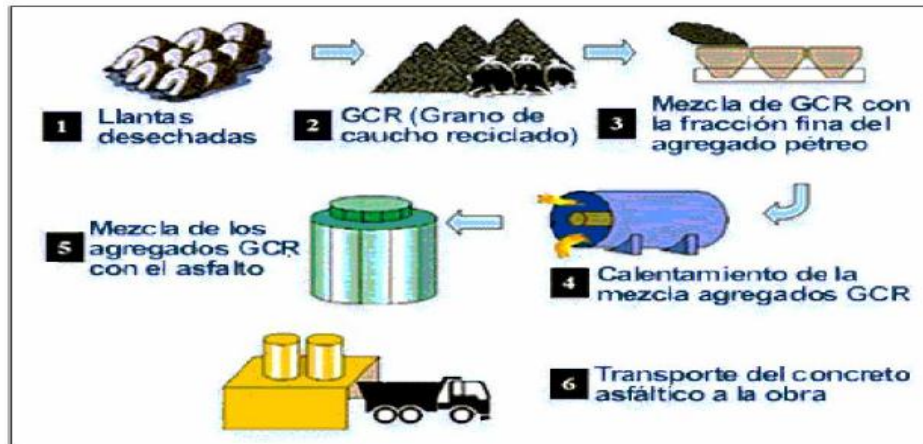
Grafico N° 5. Esquema de Fabricación de la Mezcla Asfáltica con Caucho por Vía Seca
