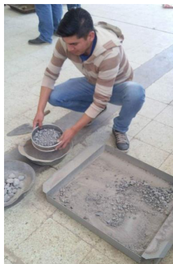
Material despues de ensayo Tamizaje del material de ensayo
