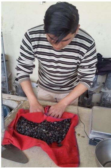
Secado superficial del agregado grueso
