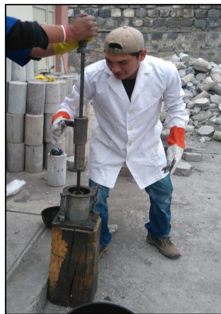
Grafico N° 14. Fabricación de las briquetas
