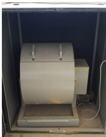
Máquina de los angeles Ensayo en la máquina de los angeles
