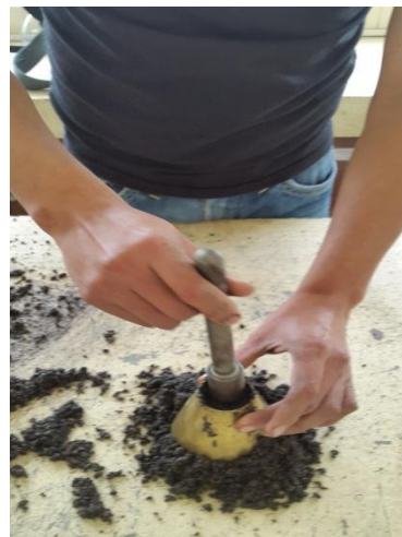
Condición de humedad de la arena
