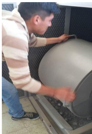
Máquina de los angeles Ensayo en la máquina de los angeles
