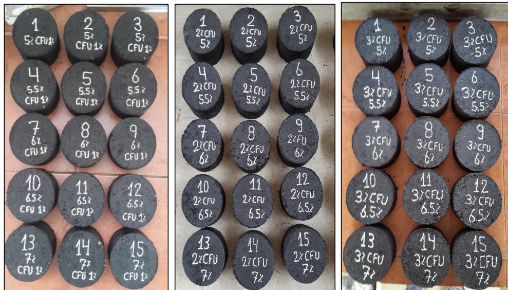
Grafico N° 34. Briquetas con caucho fuera de uso con el 1,2 y 3% (CFU)
