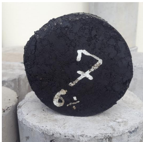
Briqueta ensayada en máquina Marshall
