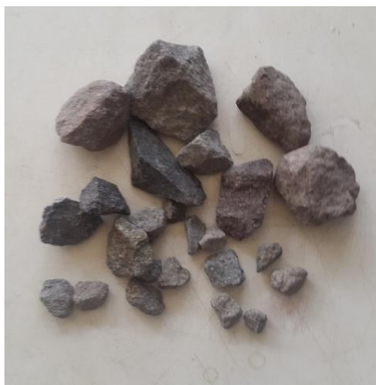
Observación de las caras fracturadas Clasificación de caras fracturadas
