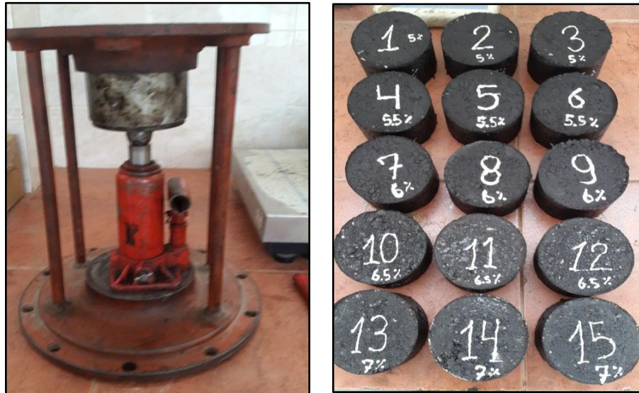
Grafico N° 15. Extracción de las briquetas
