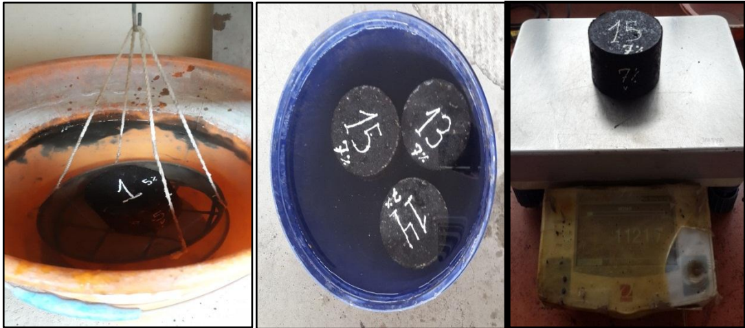
Grafico N° 17. Pesos al aire, sumergido y superficialmente saturado
