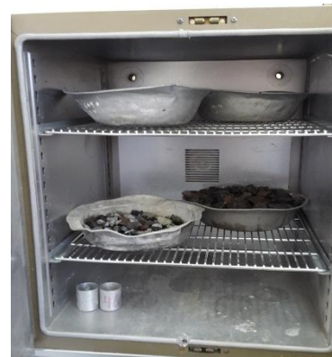
Secado del material en horno
