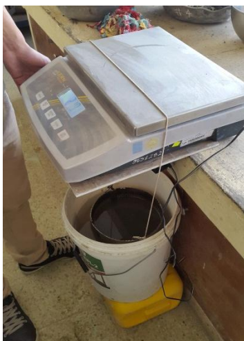
Peso sumergido en condición sss
