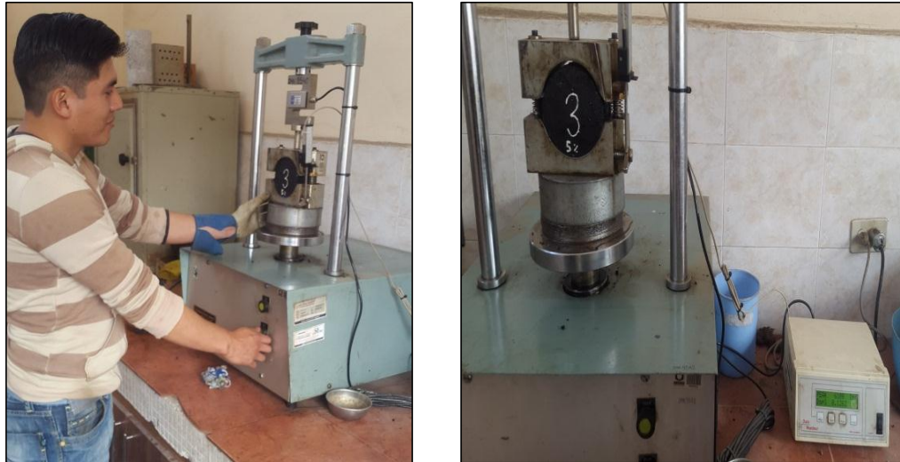
Gráfico N° 19. Ensayo Marshall de Estabilidad y Flujo
