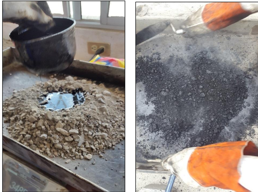
Grafico N° 31. Preparación de la mezcla modificada
