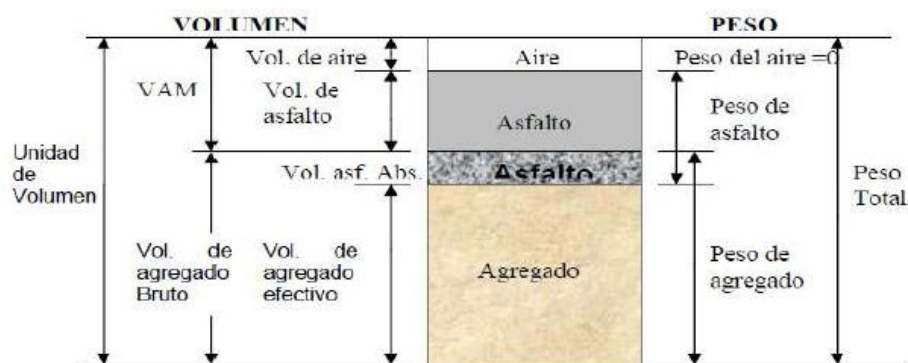
Grafico N° 1. Representación de los Volúmenes en una Briqueta Compactada de Mezcla Asfáltica.
