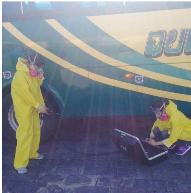
Ilustración F- 4 Medición de GEI en el tubo de escape de bus
