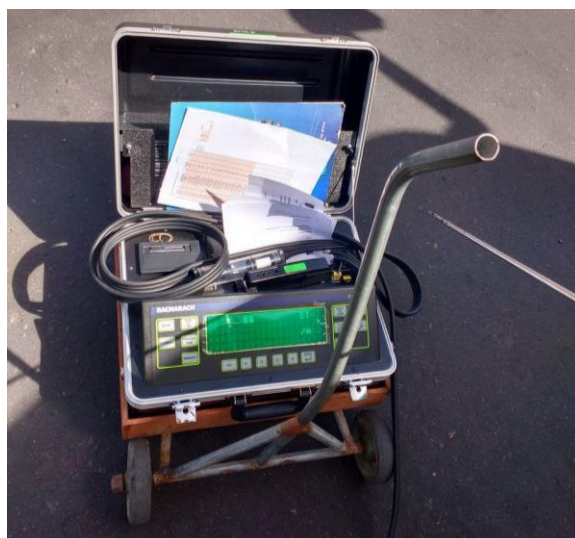
Ilustración F- 1 Equipo de Medición Bacharach ECA 450
