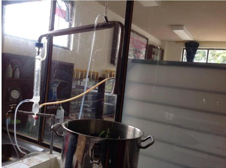
**Anexo 1. Obtención del extracto de romero por el método de destilación por arrastre de vapor.**
