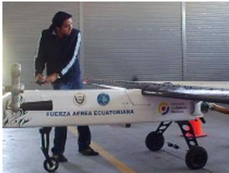
Figura N° 6.77 Apagado Inmediato de Motor y Espera de 1.5 Segundos Elaborado por: El Investigador
