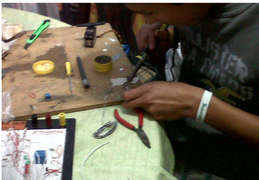
Figura N o 6.42 Soldado de elementos en la Placa de Control Elaborado por: El Investigador
