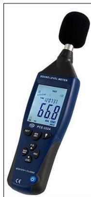
**Figura N°32:** Sonómetro PCE-322A
