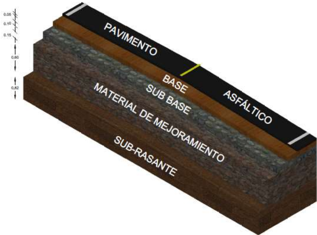
Gráfico N° 23 Espesores de la capa del Pavimento.
