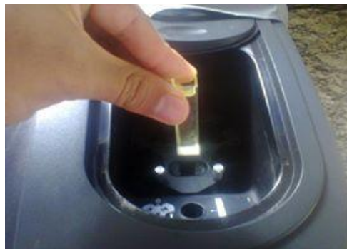
Figura 27. Determinación de absorbancia 505 nm
