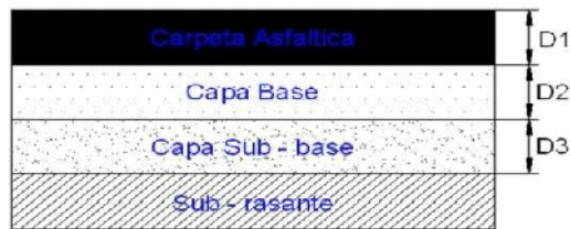
GRÁFICO 47 Espesores de la capa estructural del pavimento.
