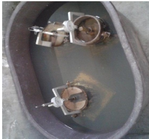
Fotografía 5. Colocación de los moldes para obtener las deformaciones
