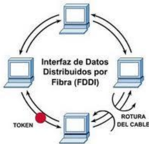
Figura 6.19. Topología de red de anillo doble.
