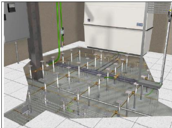
Figura N° 6.61: Enlace equipotencial debajo del piso falso Fuente: "Planning Considerations for Data Center Facilities System"
