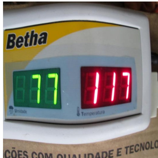
Imagen 32. Humedad relativa y temperatura de cascara de cacao y placenta de 9 horas de secado
