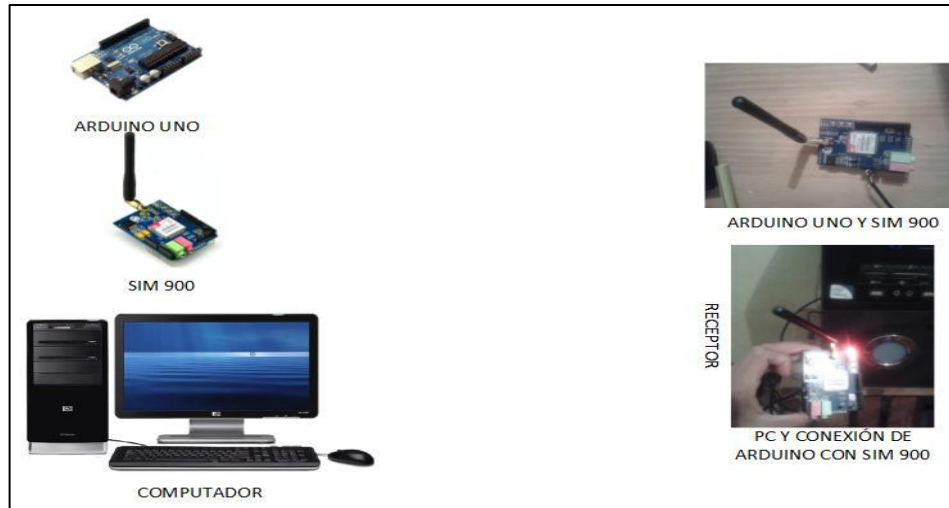
Fig. 4. 22: Receptor de datos y emisor de alerta Elaborado por: Juan Sánchez
