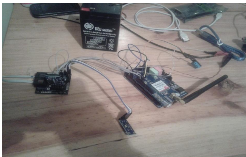
Fig. 4. 19: Conexión de los sensores y el Arduino Mega y Modulo SIM 900 Elaborado por: Juan Sánchez
