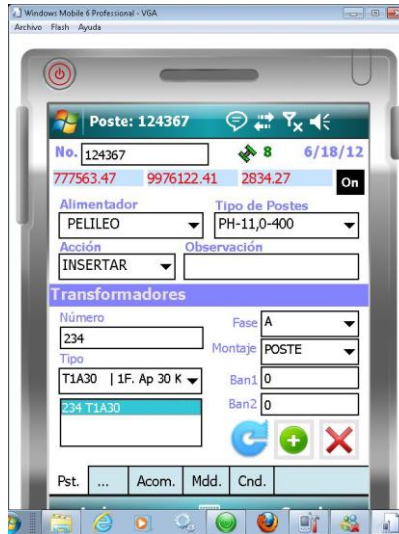
Grafico N° 6.14: Postes y Transformadores.
