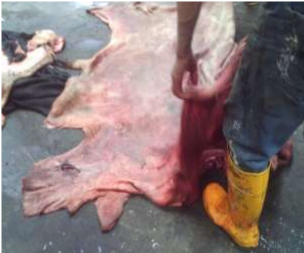
Recepción de pieles (con una mezcla de sal de mar y bicarbonato de sodio para su conservación)
