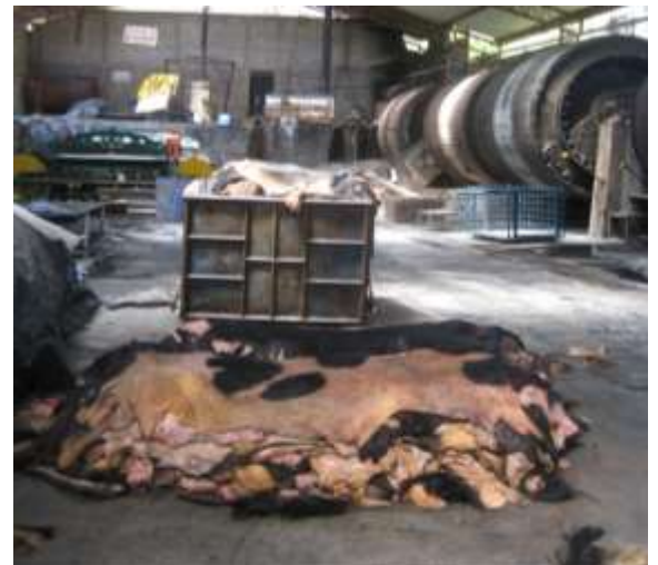
Recepción de pieles (con una mezcla de sal de mar y bicarbonato de sodio para su conservación)
