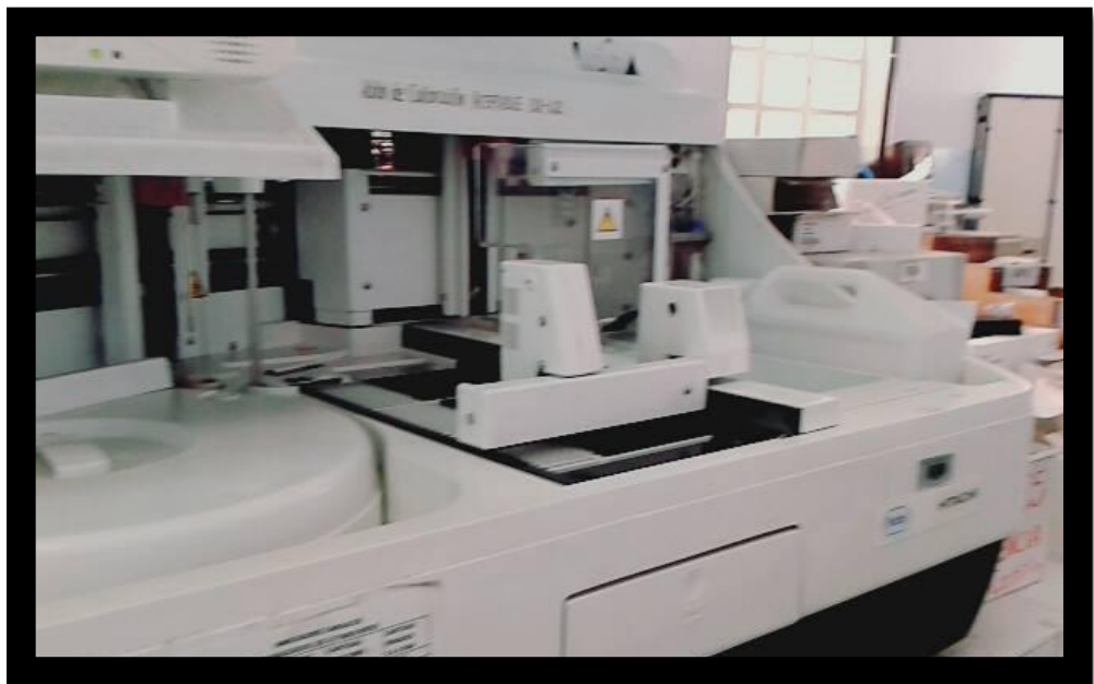
FOTOGRAFIA N°4: EQUIPO COBAS E411 PARA PROCESAR LAS MUESTRAS
