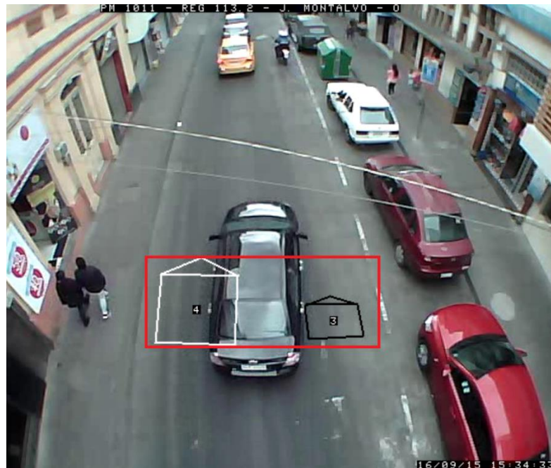
Imagen Nº 2: Encerrado en rectángulo de la sección X en la que se realiza la medición de intensidad vehicular
