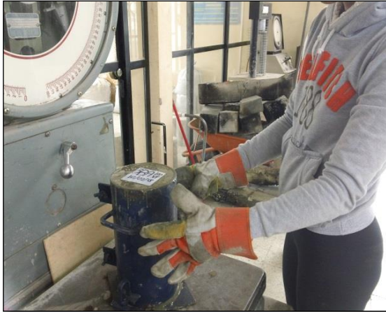
Imagen 44. Pesar el hormigón fresco Fuente propia
