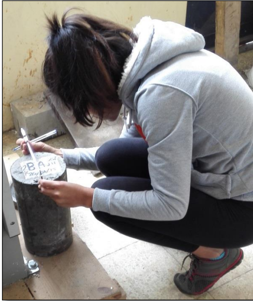
Imagen 48. Medir el diámetro de los cilindros. Fuente propia
