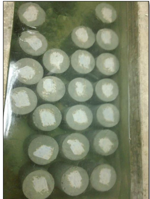
Imagen 47. Colocar los cilindros en la cámara de curado. Fuente propia
