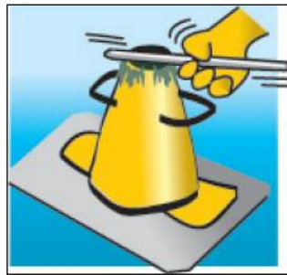
Imagen 3. Enrasado del cono de Abrams
