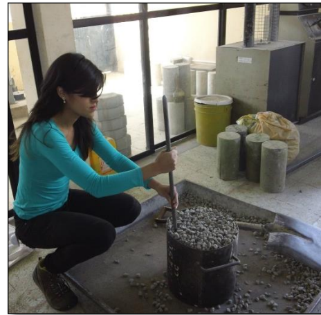
Imagen 9. Compactación de la mezcla. Fuente propia
