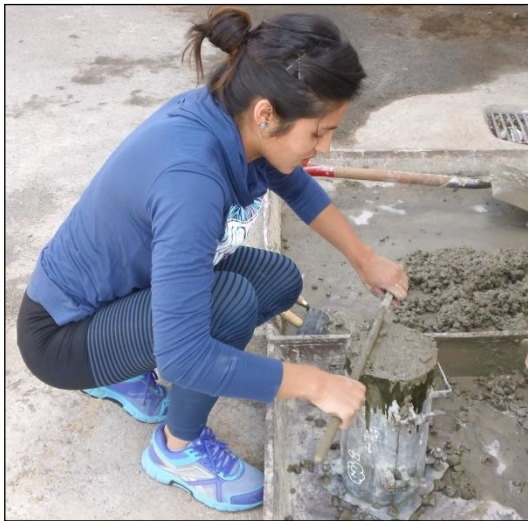
Imagen 42. Enrazando el cilindro Fuente propia
