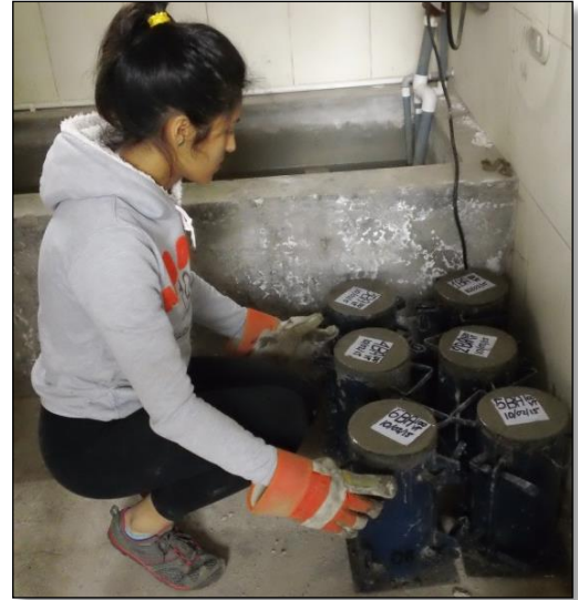
Imagen 45. Colocar en la cámara de curado por 24horas. Fuente propia
