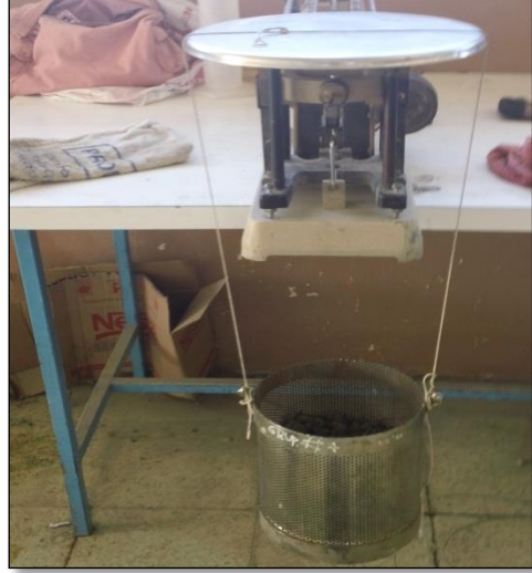
Imagen 11. Ensayo de densidad real del agregado grueso. Fuente propia
