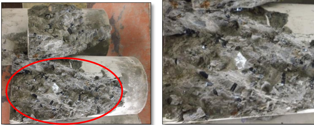
Imagen 31. Fallas en ensayos a compresión de cilindros
