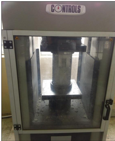
Imagen 50. Ensayo de cilindros Fuente propia
