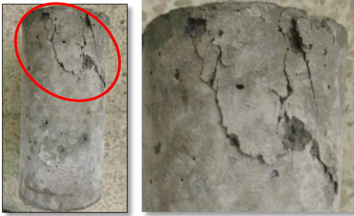
Imagen 29. Fallas en ensayos a compresión de cilindros
