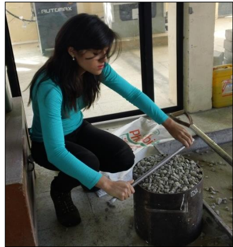
Imagen 7. Densidad aparente del agregado grueso. Fuente propia
