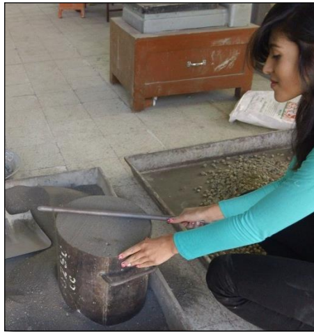
Imagen 6. Densidad aparente del agregado fino. Fuente propia
