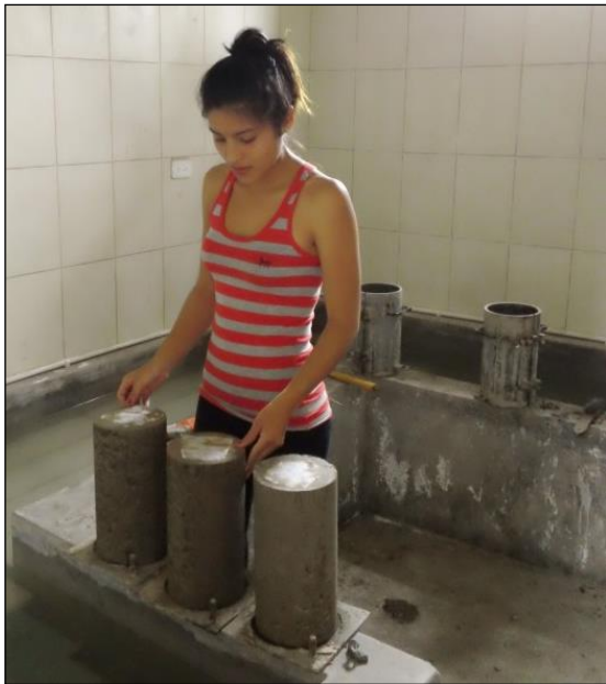
Imagen 46. Desmoldar y pesar los cilindros Fuente propia
