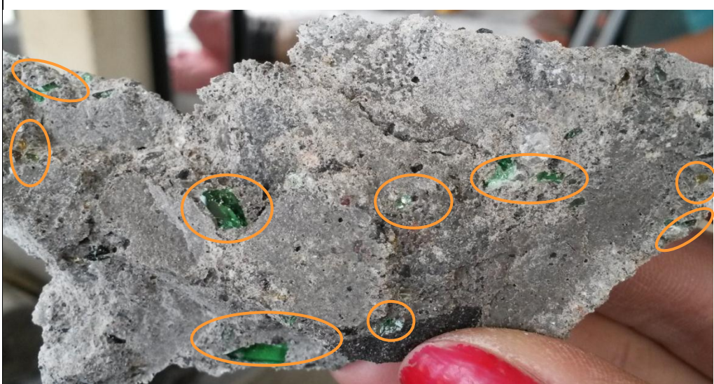
Adherencia: Ripio – Arena – Vidrio Molido – Pasta
