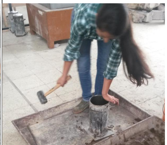
Compactación de capas de hormigón
