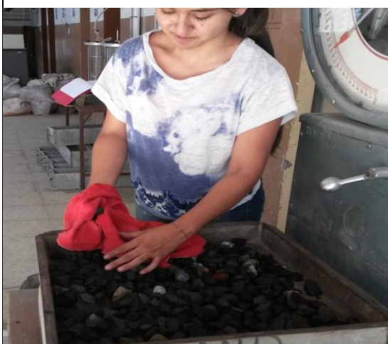
Agregado Grueso en Condición SSS
