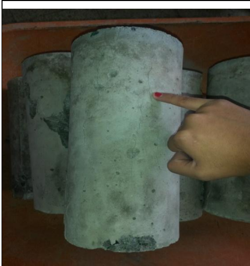
Probeta con 30% de Vidrio
