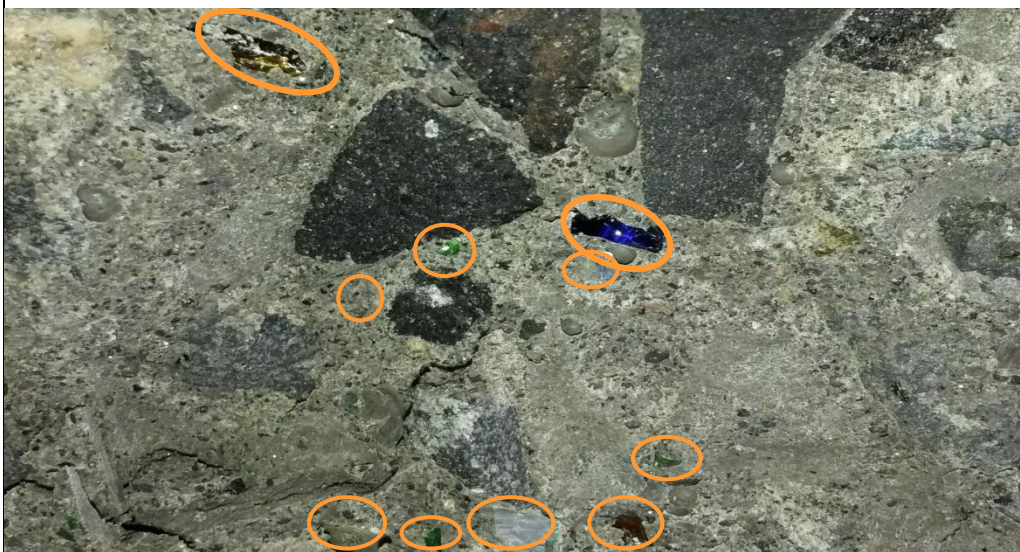
Probeta con 30% de Vidrio
