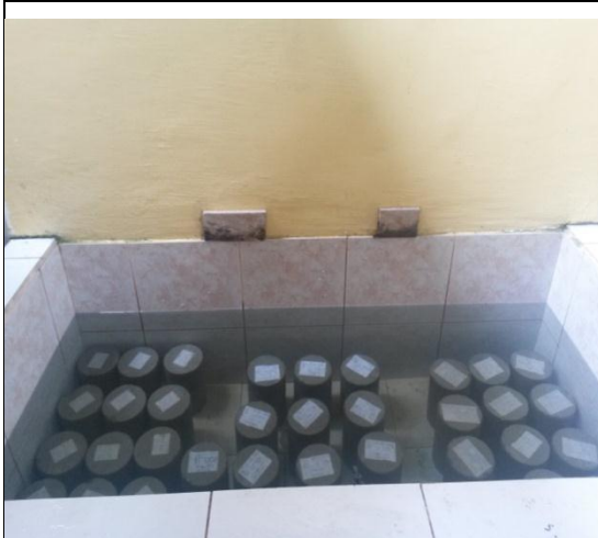
Curado de las Probetas de Hormigón
