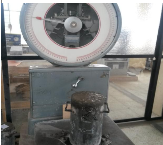
Masa de hormigón en estado fresco
