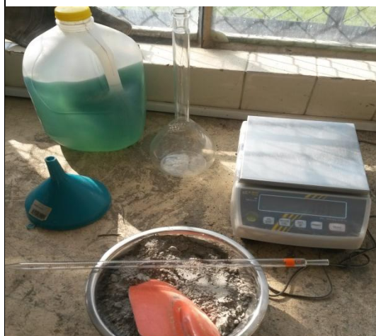
Materiales - Densidad Real del Cemento
