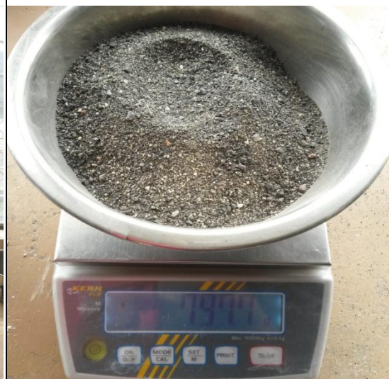
Ensayo Granulométrico de la Arena
