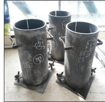
Cilindros para Hormigón
