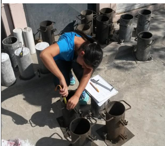
Medición de altura y \varnothing de los cilindros
