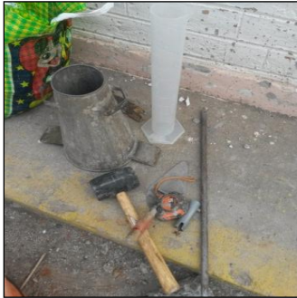
Equipo para prueba de Asentamiento y Llenado de moldes
