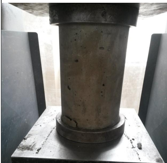
Ensayo de Cilindros a Compresión
