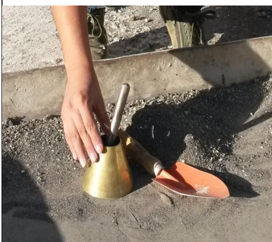
Condición de Humedad de la Arena
