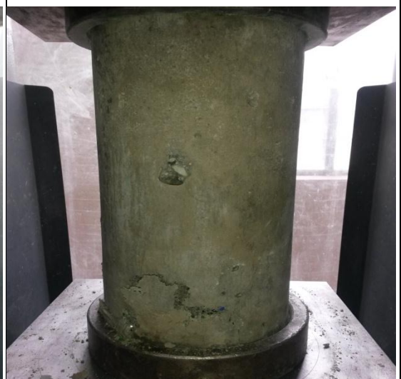
Ensayo a Compresión de Cilindros
