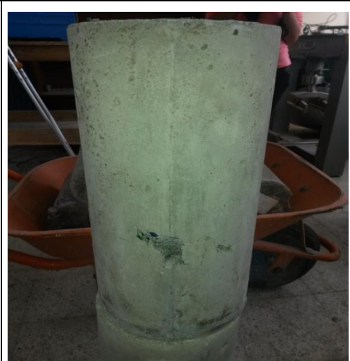
Probeta Cilíndrica con 40% de Vidrio
