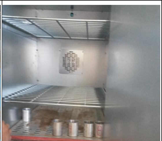
Secado al Horno de los Agregados
