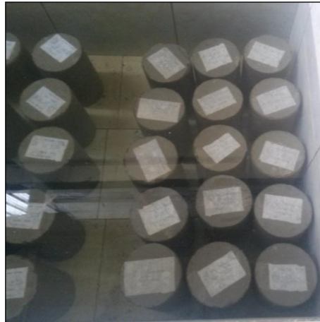
Gráfico N°17. Curado de Probetas Cilíndricas de Hormigón
