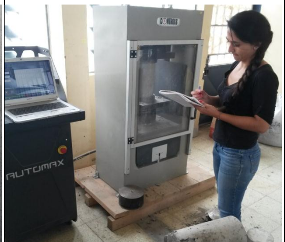
Ensayo a Compresión de los Cilindros
