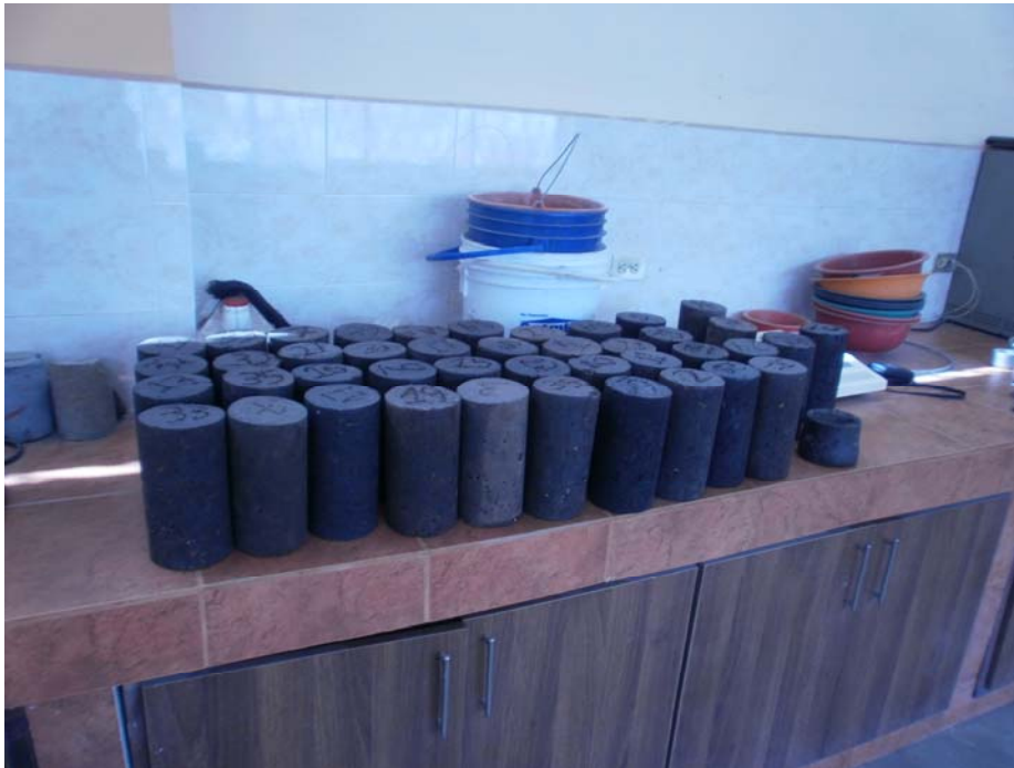
Probetas confeccionadas con suelo de subrasante y porcentajes de cal, cemento, arena y toba volcánica.
