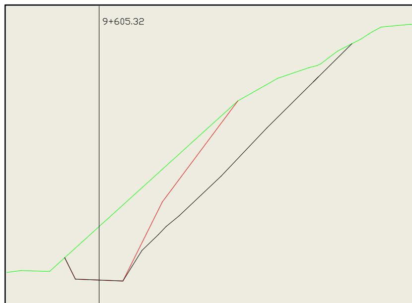
Figura 15 Geometría actual del talud Km 9+605.32
