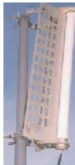
Figura 2.9: Antena sectorial de 180°.
