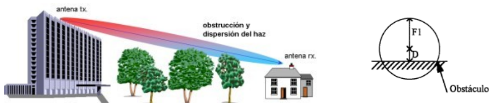
Figura 2.17: La atenuación introducida por el obstáculo es la relación entre el despejamiento y el primer radio de Fresnel D/F1 .
