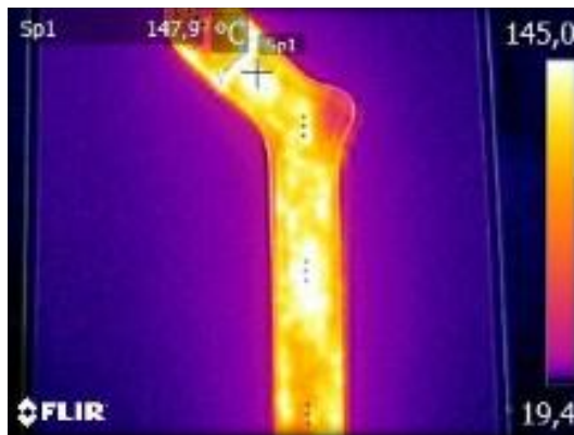
Figura 3. 4 Termografía de placa calefactora.
