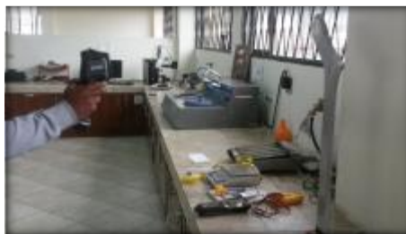
Figura 4.1 Toma de temperaturas para obtención de curva de calentamiento.
