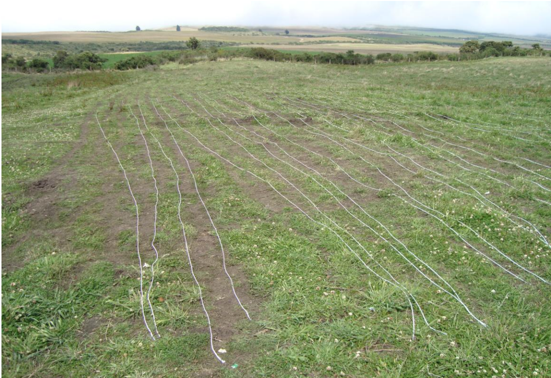
Prueba del cordón detonante (sin revestimiento)
