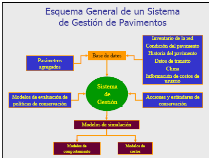
Figura 2.2 ESQUEMA GENERAL DE UN SISTEMA DE GESTIÓN DE PAVIMENTOS
