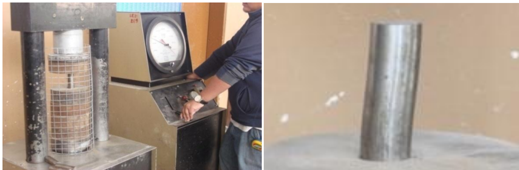
Figura 6.12. Máquina ensayo de compresión y detalle de la prueba con una presión de 60000lbf, y el efecto producido después del ensayo, evidenciando claramente la deflexión.
