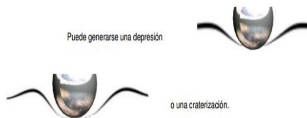
Figura 2.9. Efectos del ensayo con dureza Brinell. Fuente. http://juliocorrea.files.wordpress.com/2007/09/ensayos-de-dureza.pdf
