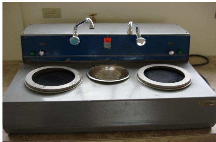
Figura 2.27. Banco de paño para pulido fino de probetas. Fuente. Laboratorios UTA-FICM
