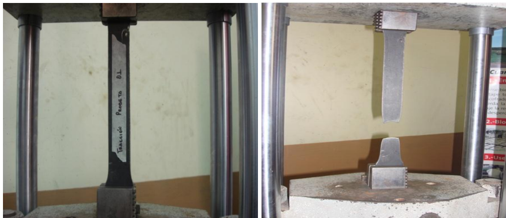
Figura 6.9. Probeta en la maquina universal, antes y después del ensayo. FUENTE: Leonardo Calero.
