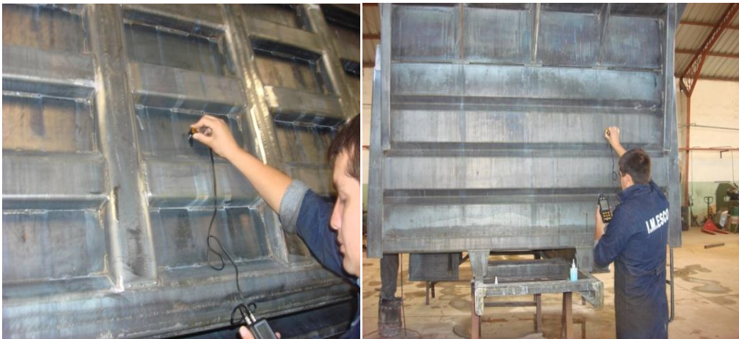
Figura 6.7. Medición de espesor en probeta de acero A36 y distribución de puntos de medición en el piso de la tolva. FUENTE: Leonardo Calero
