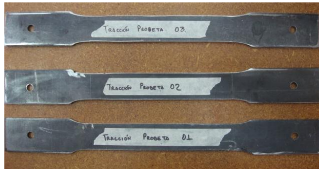
Figura 6.8. Probetas para ensayo de tracción, acero A36. FUENTE: Leonardo Calero
