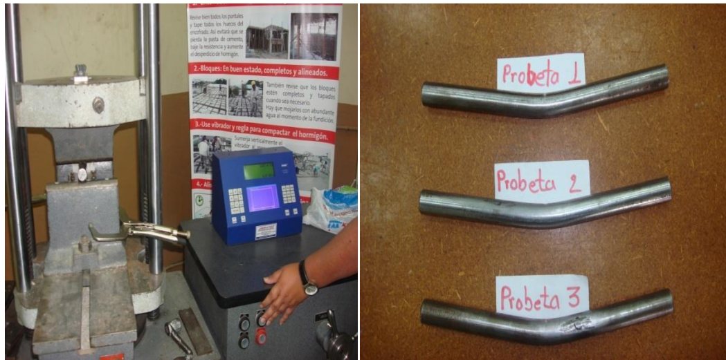
Figura 6.10. Máquina Universal, probetas del ensayo, acero SAE 1018. FUENTE: Leonardo Calero
