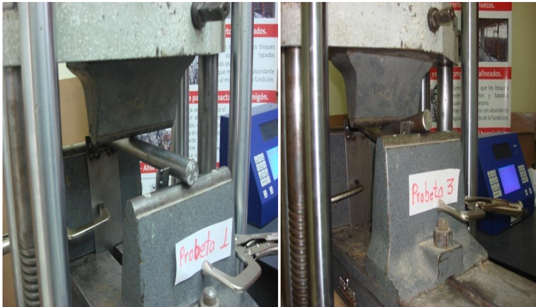
Figura 6.11. Máquina Universal, probetas del ensayo, y ejecución, en acero SAE 1018. FUENTE: Leonardo Calero
