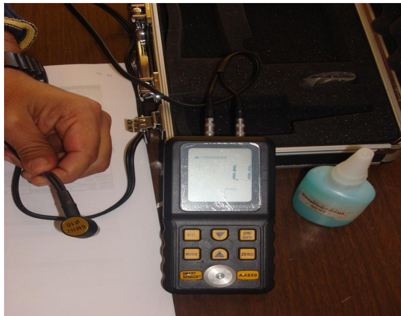
Figura 2.15. Equipo de ultra sonido Fuente. Laboratorios UTA-FICM
