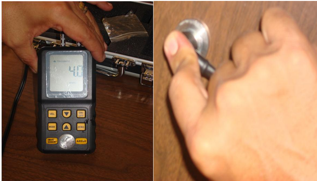
Figura N° 6.5. Medidor de espesores, calibración. FUENTE: Leonardo Calero
