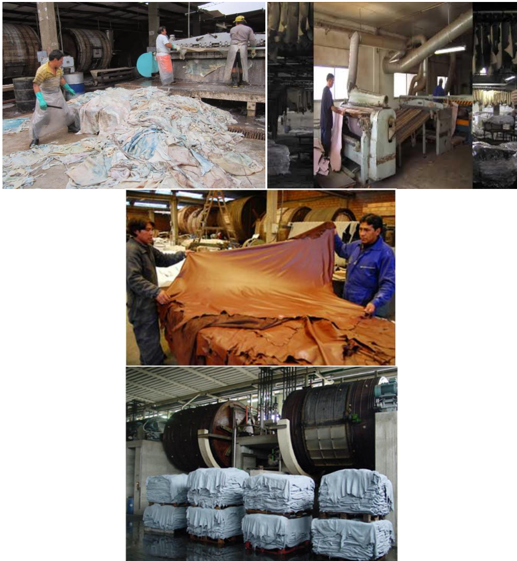
Figura No.6: Proceso de la piel en curtiembre Elaborado por: Vinicio Núñez Fuente: Observación directa
