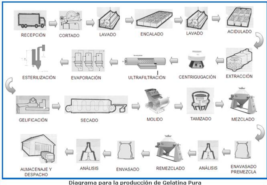
Figura No.20: Diagrama gráfico para la producción de gelatina pura
