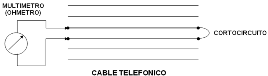
Fig. 31 Medición de la resistencia de bucle.
