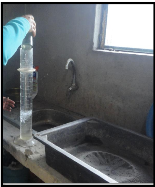
Imagen N°2- Porcentaje determinado de agua para la muestra
