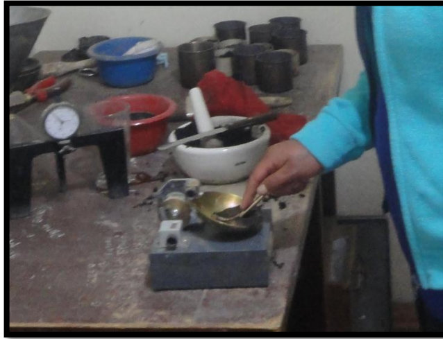
Imagen N° 1- Ensayo Límite Líquido Copa Casagrande
