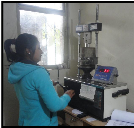
Imagen N° 5- Penetración de la carga
