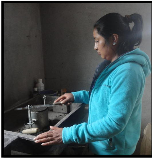
Imagen N° 4- Enrasamiento del cilindro
