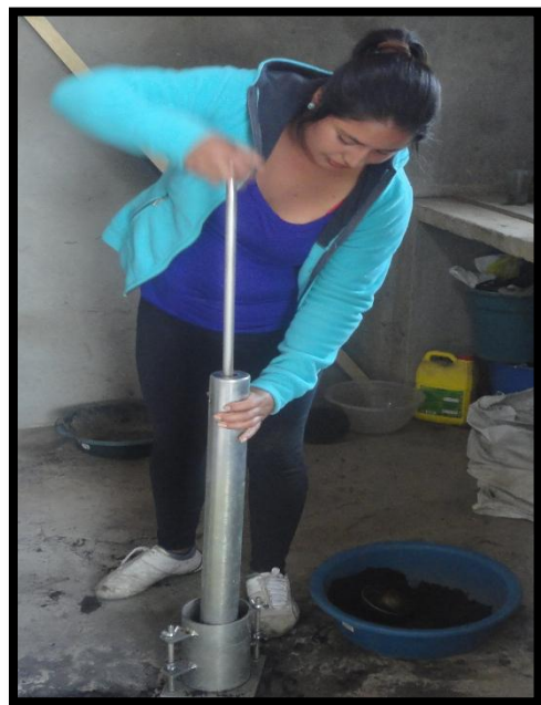
ImagenN°3 - Compactación de la muestra
