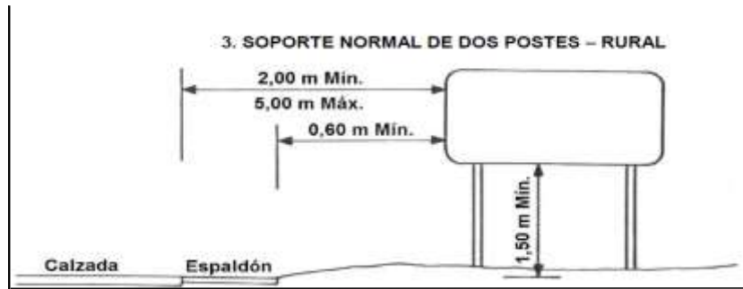
Gráfico 44: Colocación de señalización
