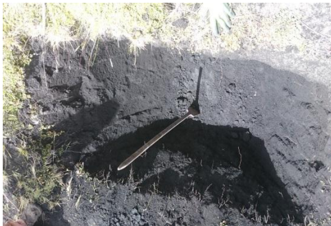
Calicata de 1,50 m de prof.
