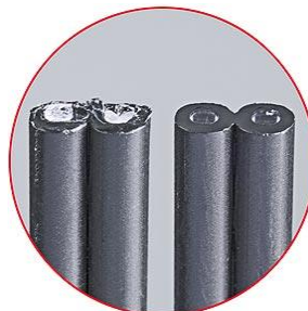
Figura 4. 13: Corte de Fibra Óptica Fuente: Investigador
