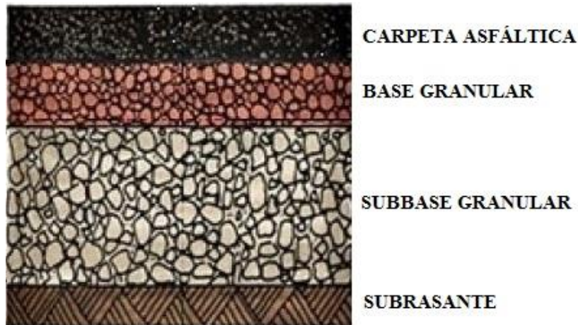
Gráfico N°. 13 Estructura de un pavimento flexible
