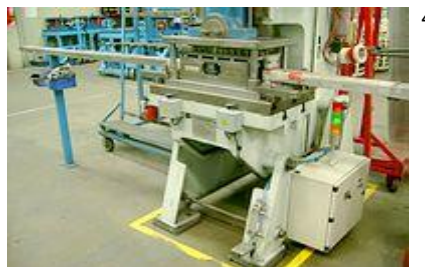
Fig.2.4 Troqueladora Poka Yoke
