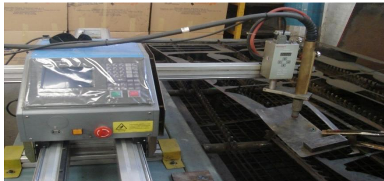
Fig6.3 Cortado de contra placa
