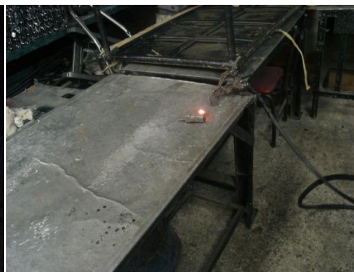
Fig6.3 Soldadura de bisagras
