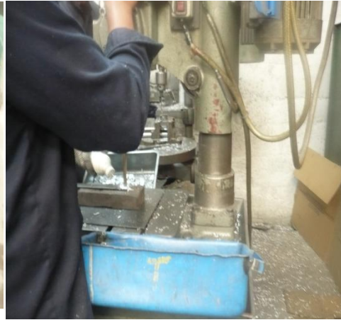
Fig6.2 Perforaciones en las platinas
