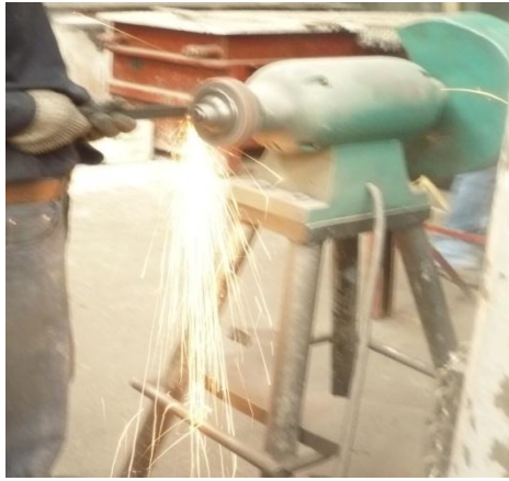
Fig6.1 Esmerilado de platinas
