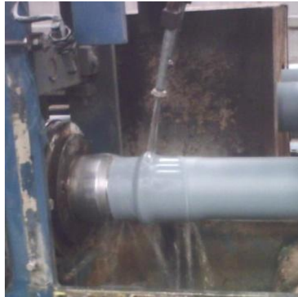
FIGURA 2.14 ENFRIAMIENTO DE LA TUBERÍA (FUENTE: ELABORADO POR AUTOR)
