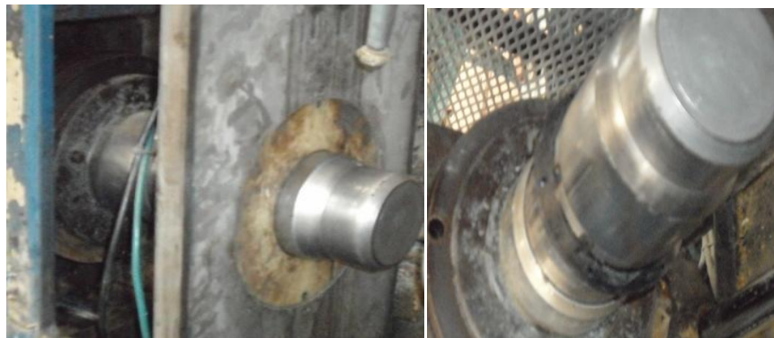
FIGURA 2.16 COLOCACIÓN DEL SELLO EN EL MANDRIL (FUENTE: ELABORADO POR AUTOR)
