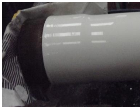
FIGURA 2.10 FORMACIÓN DE LA UNIÓN CEMENTADA (FUENTE: ELABORADO POR AUTOR)
