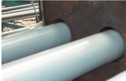
FIGURA 2.12 ABLANDAMIENTO DE TUBERÍA (FUENTE: ELABORADO POR AUTOR)
