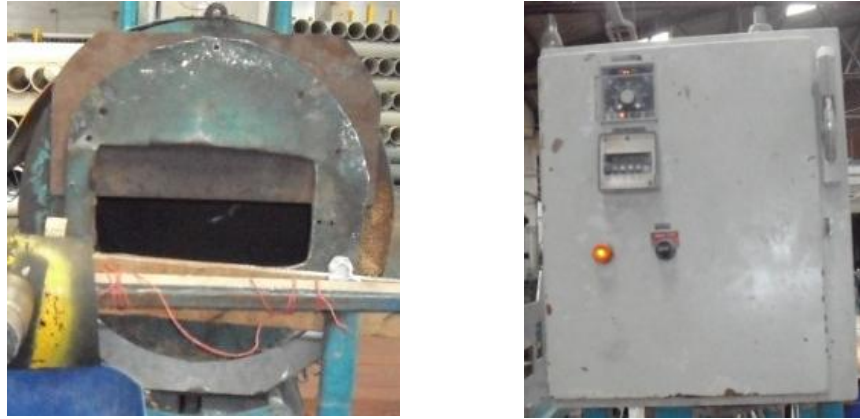
FIGURA 2.6 HORNO DE CALENTAMIENTO Y PANEL DE CONTROL (FUENTE: ELABORADO POR AUTOR)
