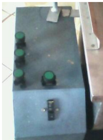
Fig. 6.12: Disposición de las Botoneras para la automatización
