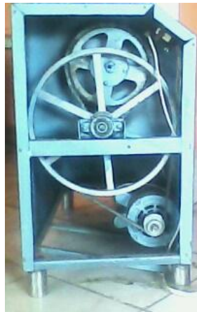
Fig. 6.11: Sistema de transmisión de la máquina
