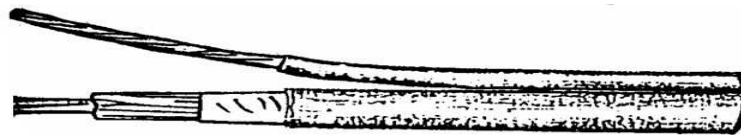
Figura 2.17: Cable autosuspendidos relleno con aislamiento de polietileno, pantalla de aluminio, tipo ELAC, EMETEL tipo 3
