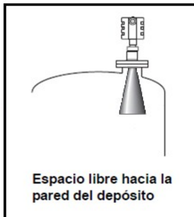
Figura 5.45. Montaje recomendado del medidor
