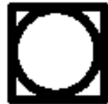
Figura 2.5 Operación con inspección
