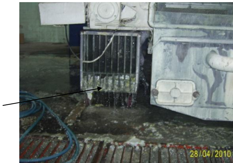
Imagen 6. Residuos de las etiquetas luego de lavadas las botellas.
