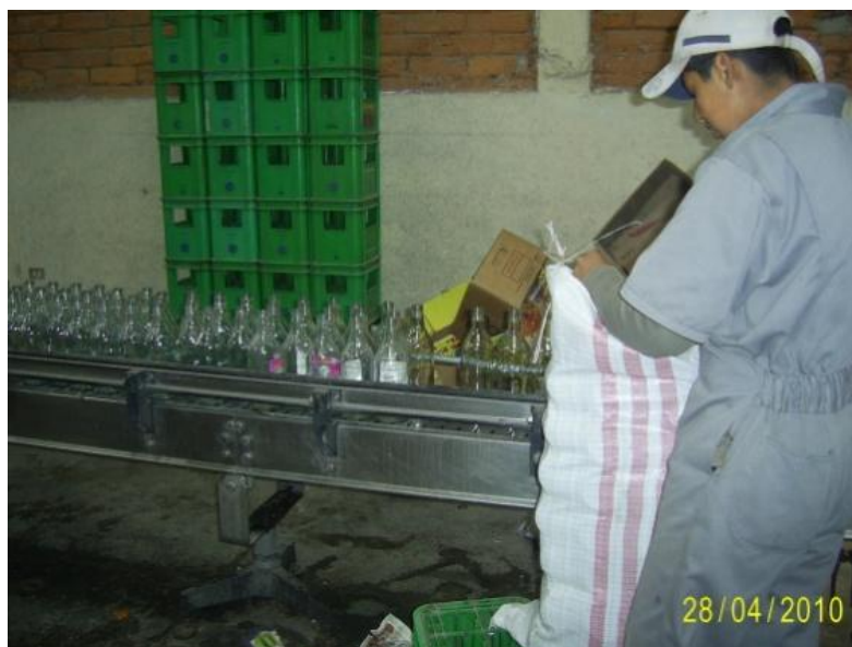
Imagen 1. Instante en el que se carga las botellas antes de ingresar a la lavadora
