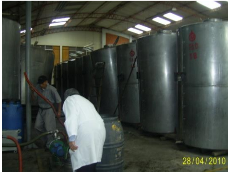
Imagen 7. Instantes en que se preparaba el transporte del licor. (Tanques de decantación de acero inoxidable en los cuales reposan vinos y licores antes de ser envasados).
