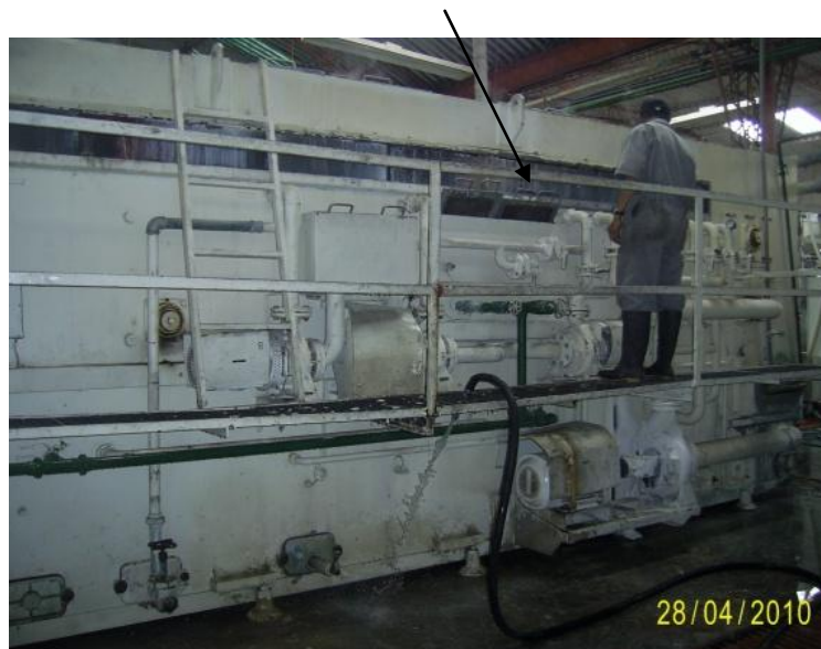
Imagen 4. Aquí podemos observar la limpieza de los filtros de la lavadora con agua a presión. Este proceso se lo debe realizar cada 15 minutos. Cabe mencionar que la lavadora tiene su propio caldero.
