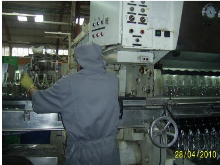
Imagen 9. Aquí vemos el proceso de llenado (Vinos o licores), la cual es regulable (Altura) para cada tipo de botellas.
