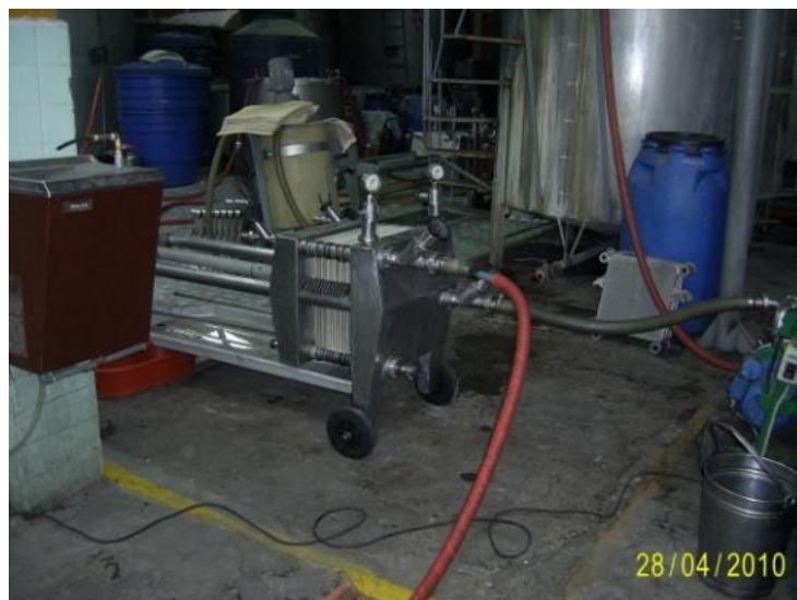
Imagen 8. Filtro a prensa el cual consta de 30 placas de celulosa de 40x40, exclusiva para vinos y licores.
