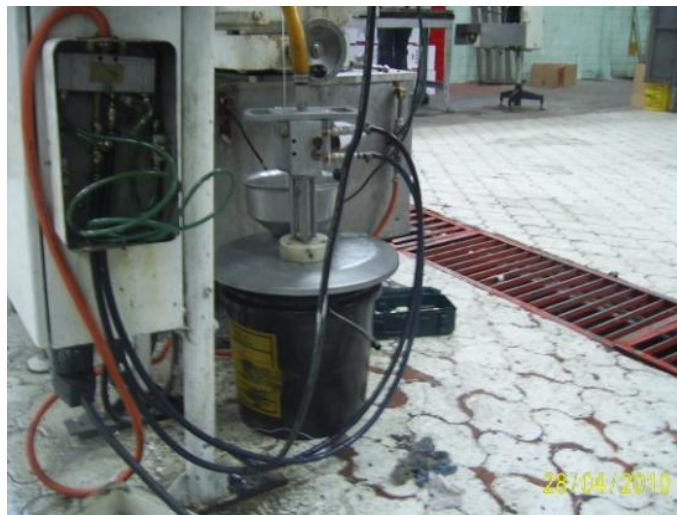
Imagen 12. Etiquetadora automática (Hidroneumática), posee una pega especial para etiquetar las botellas antes de ser empacadas.
