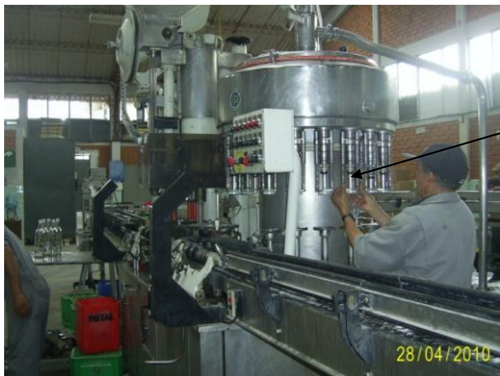
Imagen 10. Cambio de las capsuladoras por motivo que se ingresarán botellas de mayor altura.
