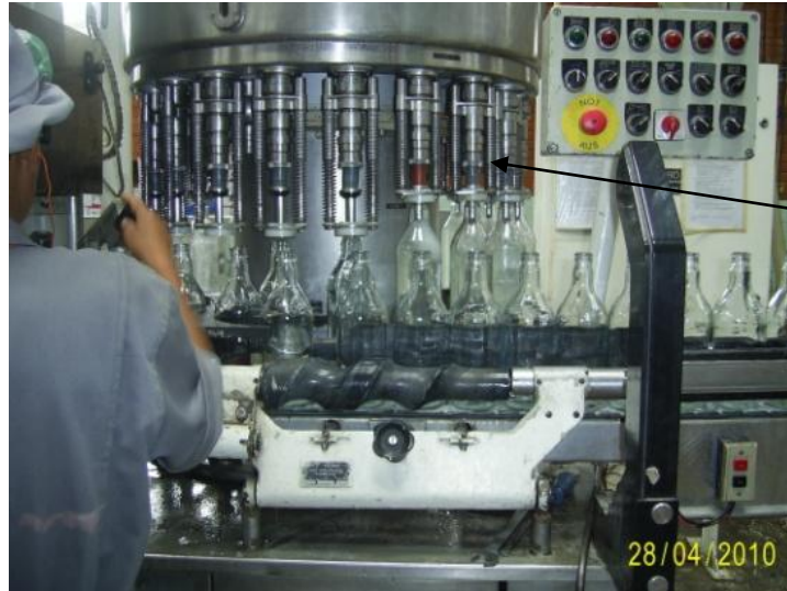
Imagen 11. Capsuladoras cambiadas y listas para seguir trabajando. La llenadora automática envasa y capsula la misma que tiene una capacidad de producto terminado de 1000 botellas/hora.
