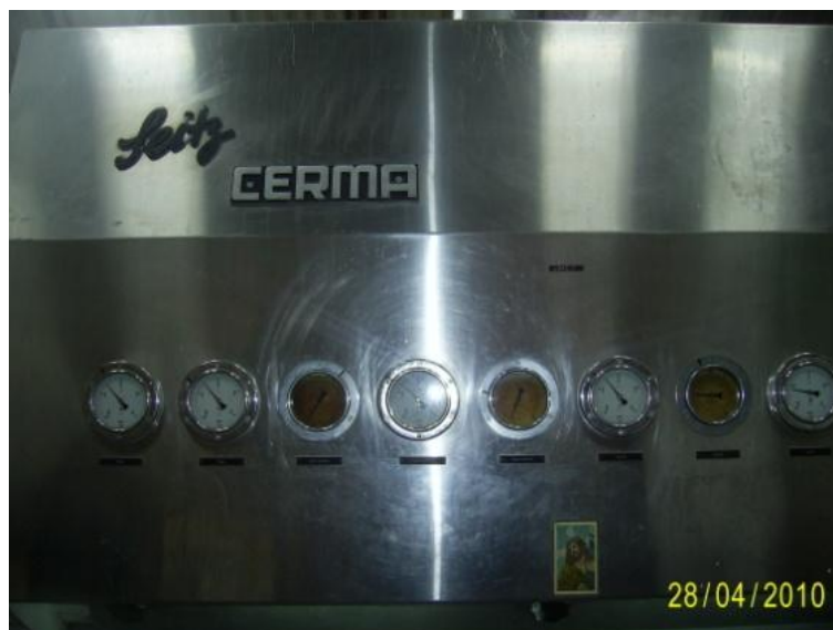
Imagen 2. Lavadora de botellas Cerma 16W en proceso de pre encendido, en el cual se tuvo que esperar un lapso de 2 horas para su encendido.
