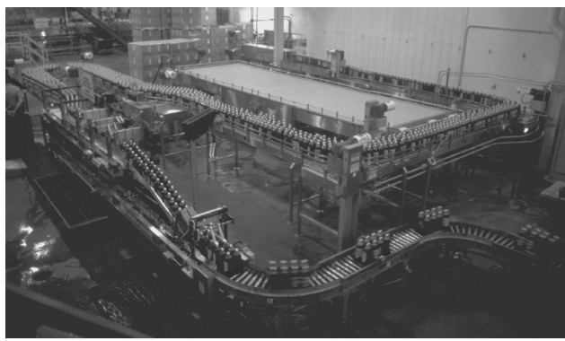
Figura 65.4 • Paquetes de 8 botellas de plástico de 2 litros de bebidas refrescantes de camino a un apilador automático.
