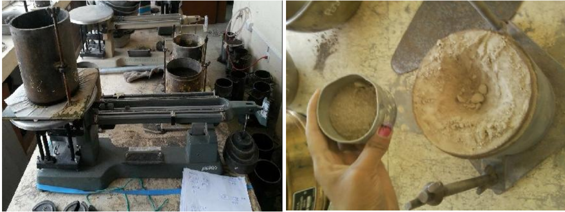
Actividades del Ensayo de compactación método A.A.S.H.T.O. modificado
