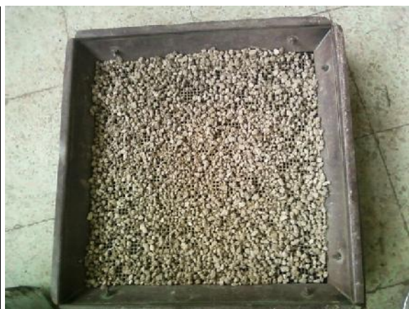
Ensayo de granulometría tamices cuadrados
