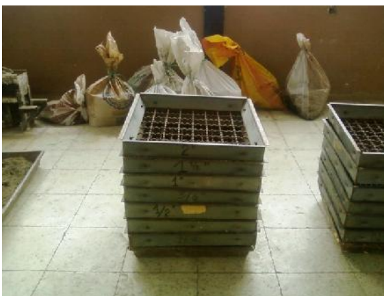
Ensayo de granulometría tamices cuadrados
