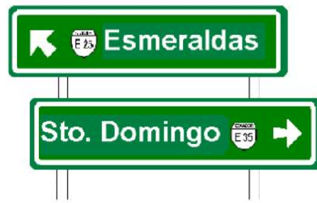
Ilustración 67: Señal de información de disposición alterna para señales ejecutivas de destino
