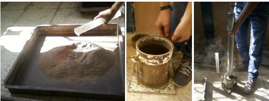
Ensayo de compactación método A.A.S.H.T.O. modificado
