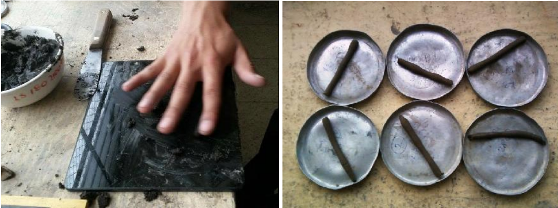
Ensayo de límite plástico (LP)
