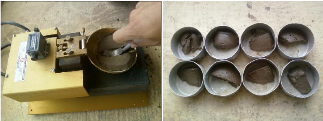
Ensayo de límite líquido (LL)
