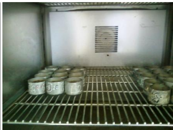
Ensayo de contenido de humedad (W%)
