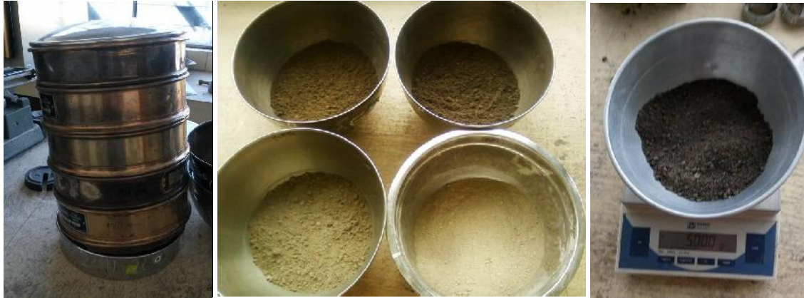
Ensayo de granulometría tamices redondos
