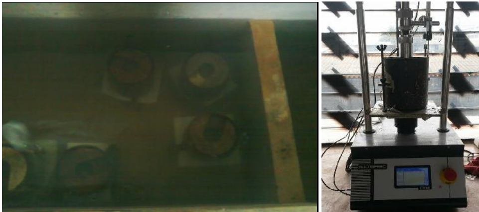
Actividades del Ensayo de compactación método A.A.S.H.T.O. modificado
