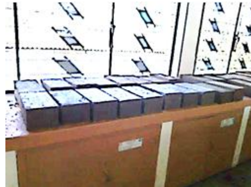
BLOQUES EN SECADO PARA EL ENSAYO
