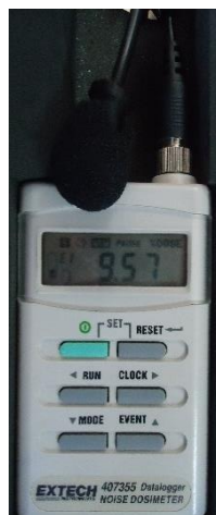
Fig. 26: Dosímetro Extech 407355 Fuente: Manual Dosímetro Extech 407355 Elaborado por: Israel Orozco
