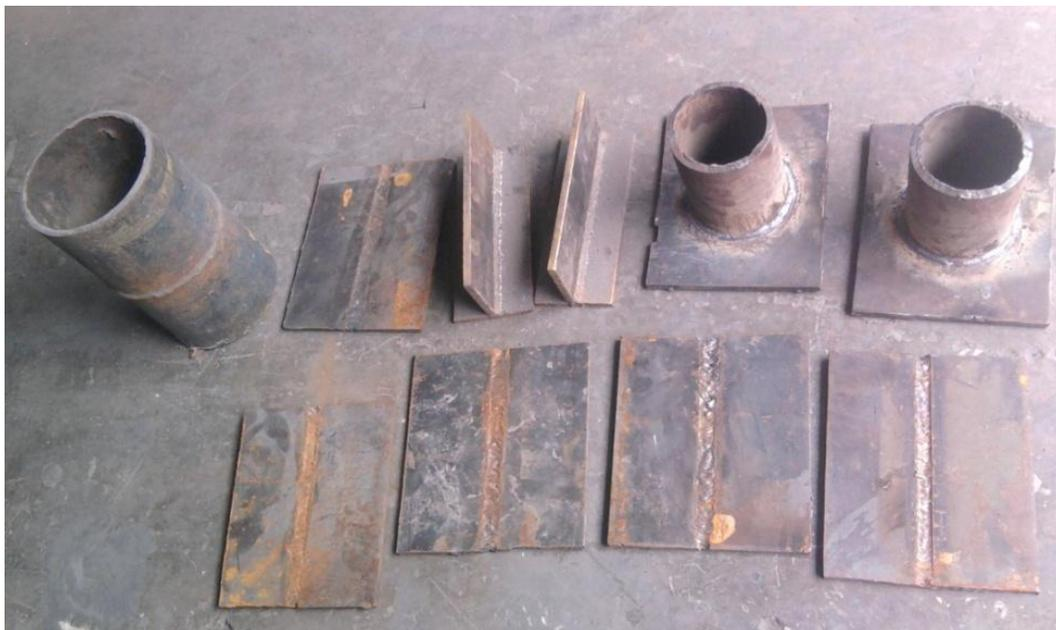
Gráfico 6.3 Placas (acero ASTM A36) y tubería (acero ASTM A53 Gr B).
