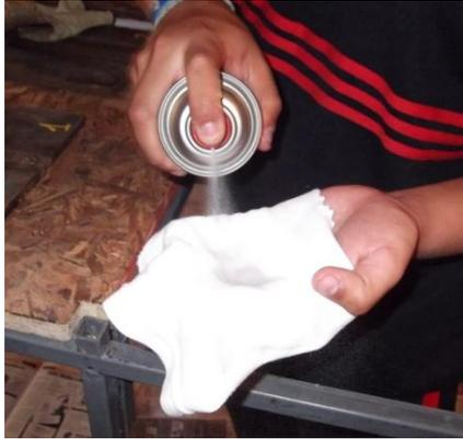
Grafico 6.8 Aplicación del paño con cleaner sobre la probeta.
