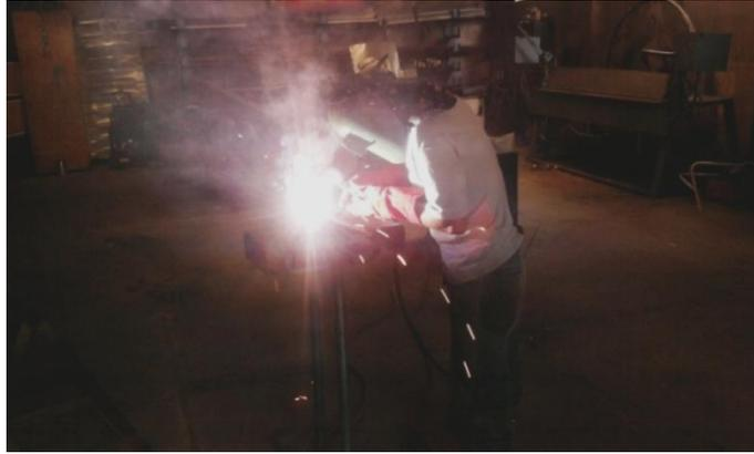
Gráfico 6.6 Probetas en proceso de soldadura.
