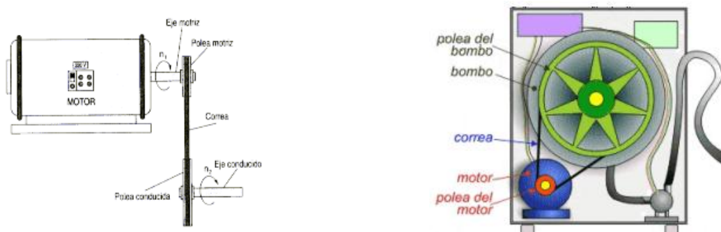
FIGURA 2.7 Sistemas de poleas con correa
