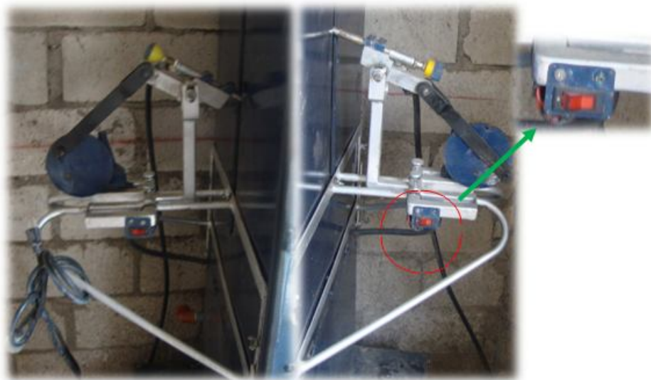
Figura 6.9. Pulsadores de encendido y apagado de los motores de los mecanismos que transmiten movimiento a las lanzas.
