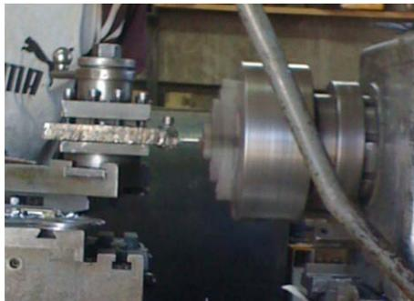
*Figura 6.16: Torneado de los ejes para el acople a la compuerta
