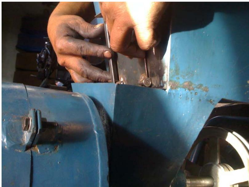
*Figura 6.20: Guías para el deslizamiento de la compuerta*
