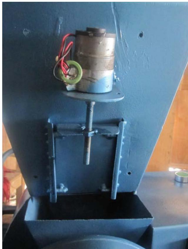
*Figura 6.24: Montaje de la compuerta y el motor
