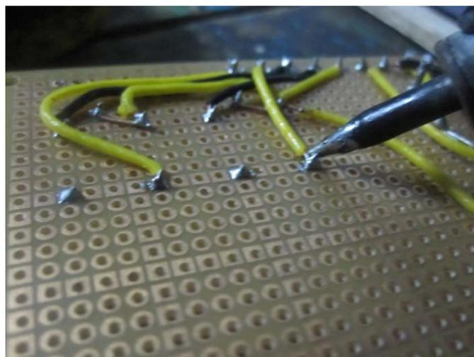
*Figura 6.28: Soldadura de los dispositivos eléctricos
