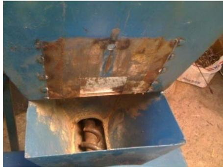
*Figura 6.14: Desensamble de la compuerta
