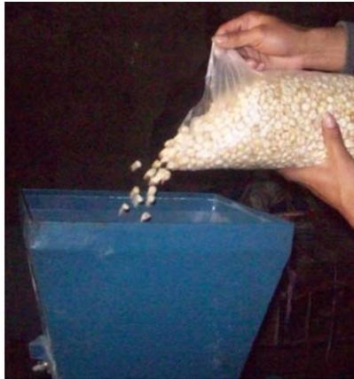
*Figura 3.2: Vaciado del Maíz Blanco en la tolva del molino
