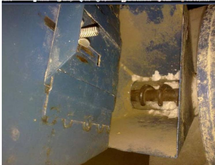
*Figura 2.27: Dosificador del Molino de Piedra*
