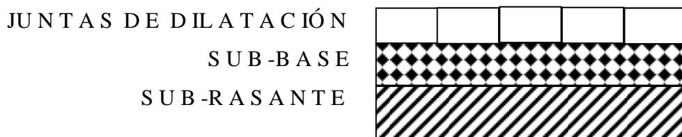
Figura 2.1.9.1. - Sección transversal típica de un pavimento rígido.
