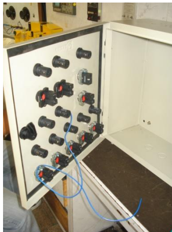
Figura 6.17 Ajuste de los push button
