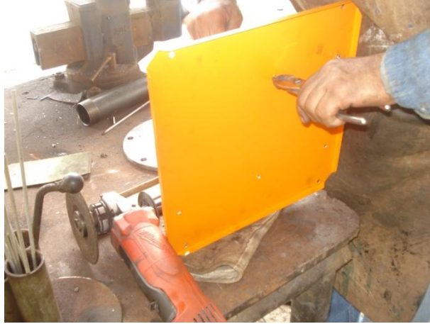
Figura 6.11 Perforación y ajuste del tablero
