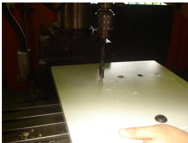
Figura 6.15 Perforación del tablero para la colocación de los push button
