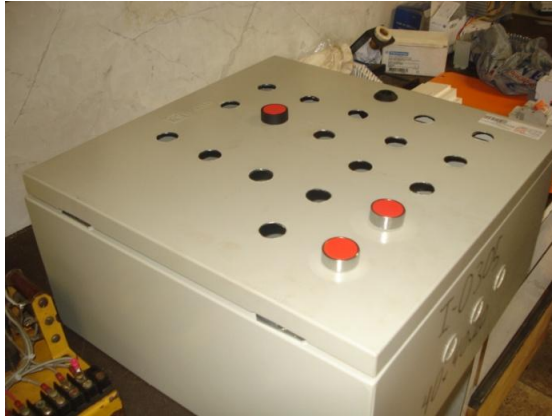
Figura 6.16 Colocación de los push button
