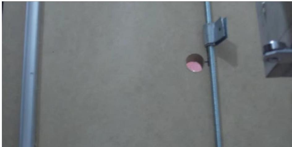
**Figura 79:** Montaje de varilla roscada y cupla eje X
