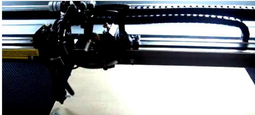
**Figura 117:** Corte Laser de piezas en material sintético Beige.
