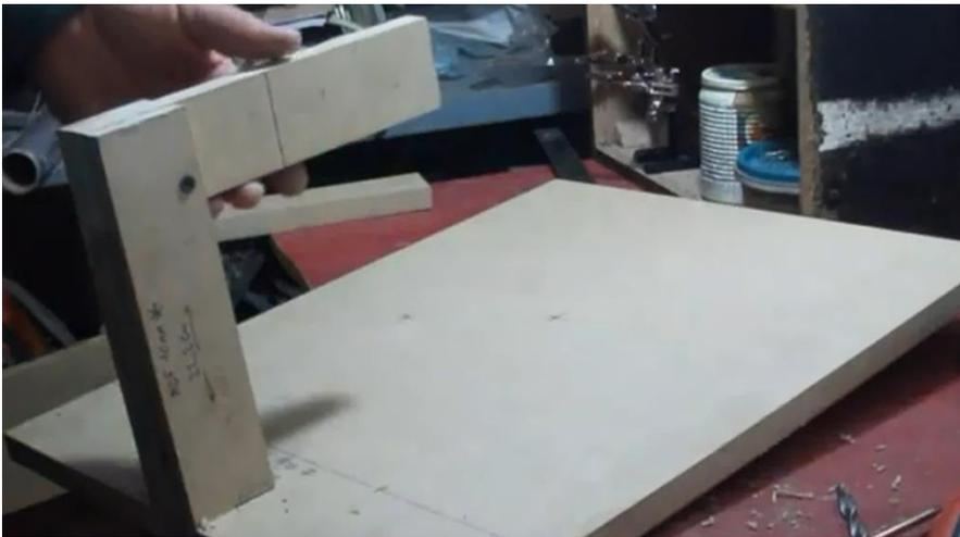
**Figura 58:** Fijación eje X y Z.
