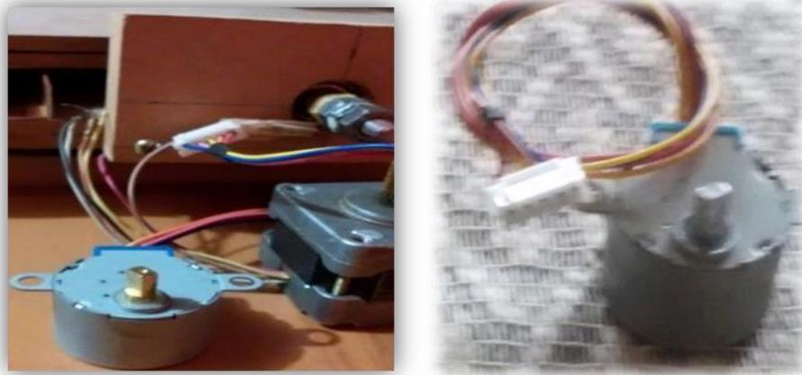
**Figura 89:** Motor paso a paso 28Byj-48 C [Anexo 40]
