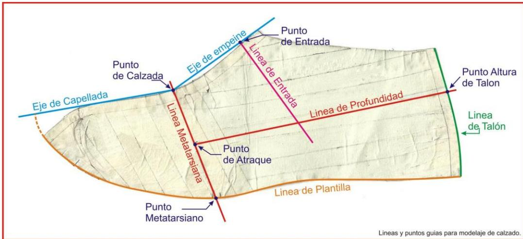
Figura 4 Diagrama proceso de modelaje y moldes de calzado [26]
