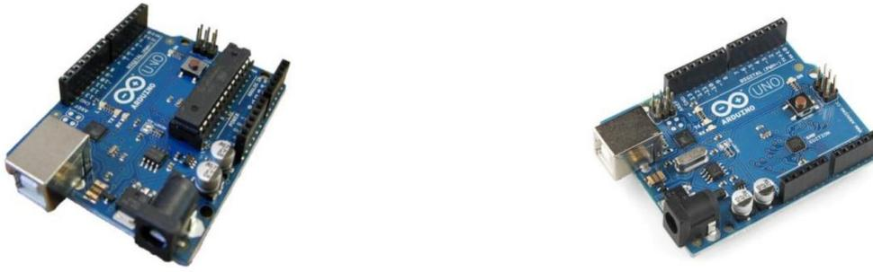
Arduino UNO con microcontrolador en formato DIP
