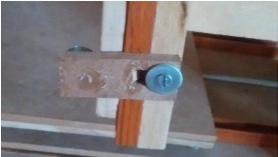
**Figura 74:** Colocación de placa eje Z
