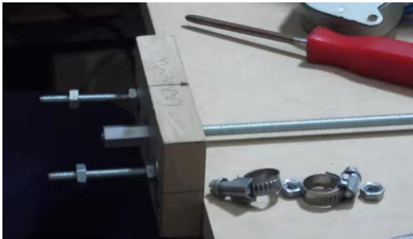
**Figura 81:** Montaje de tornillo motor eje X
