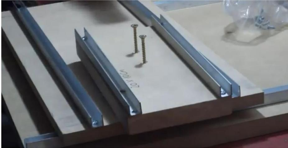
**Figura 62:** Ejes guías soporte herramienta eje Z.
